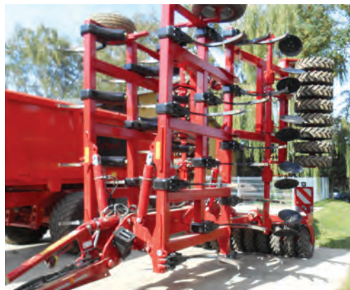
Fot. 2. Ciężki kultywator do uprawy konserwującej
