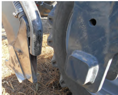
Fot.8.Przykład redlicy spulchniającej wysiewającej nawóz w całym profilu glebowym
