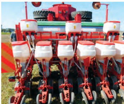
Fot.5. Siewnik punktowy sekcji wysiewającej
