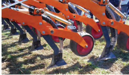
Fot.7. Redlice z przewodami wysiewającymi nawóz
