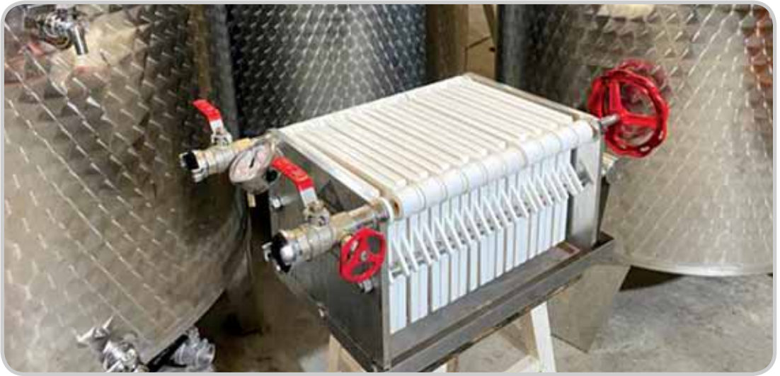
Fot. 12. Filtr ramowo-płytkowy na płyty o wymiarze 20x20 cm, Winnica Łukasz w Wityniu, zdjęcie Zuzanna Pietrasik Snowball.
