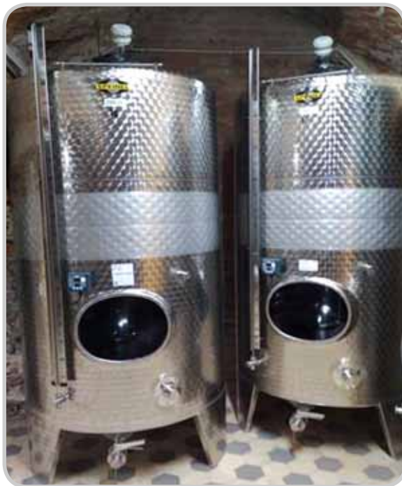
Fot. 5. Tanki fermentacyjne, widoczny wskaźnik poziomu cieczy oraz płaszcz chłodzący. Winnica Folwar Pszczew, zdjęcie Sylwia Bonin.
