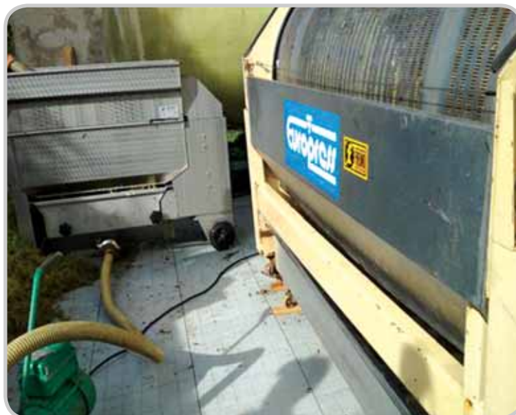
Fot. 2. Młynkoodszypułkowarka połączona z prasą hydrauliczną, Winnica Folwark Pszczew, zdjęcie Sylwia Bonin.
